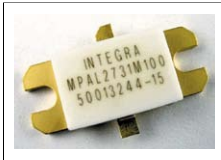
Рис. 10. Миниатюризованный усилитель MPAL2731M100 с высокой выходной мощностью
