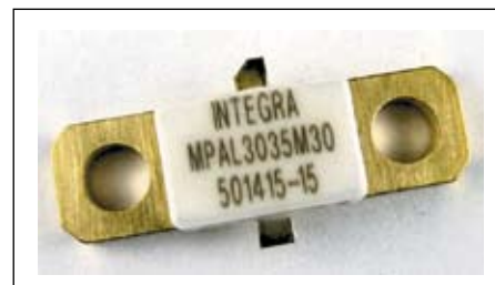
Рис. 7. Миниатюризированный усилитель мощности MPAL3035M30, выполненный по LDMOS-технологии, обеспечивает выходную мощность более 30 Вт в диапазоне частот 3–3,5 ГГц
